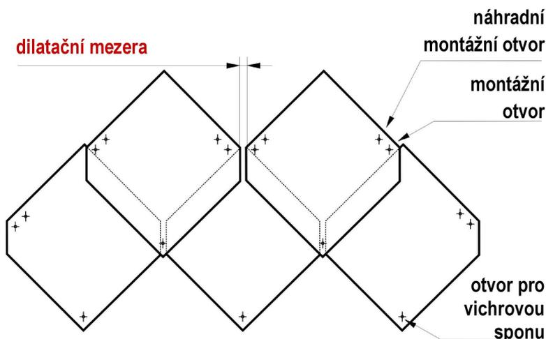
**SK3 – šupina** se přibíjí v místě připravených otvorů a ve spodní části se zajišťuje vichrovou sponou 25 x 27 mm. Při pokládce dojde k proklepnutí okraje spodní šupiny.
